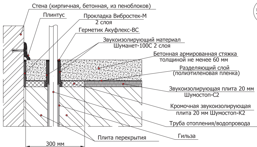
5.4.3 Схема примыкания конструкции плавающего пола с применением звукоизолирующих плит Шумостоп в один слой к стене и трубе отопления/водопровода
